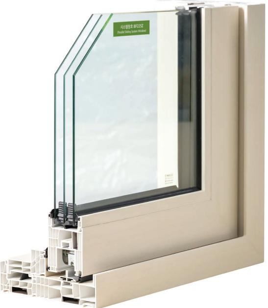
한국형 슬라이딩 시스템 창호인 'IBF225Z'는 개폐 시 창짝 4면이 완벽하게 밀착되는 고밀착 슬라이딩 작동 방식의 특수 하드웨어를 적용했다. 이로 인해 미세먼지, 황사 등 차단 효과는 물론, 빛과 유입을 방지하는 수밀성<sup>1)</sup>과 기밀성<sup>2)</sup>, 단열성능을 극대화한 제품이다.
