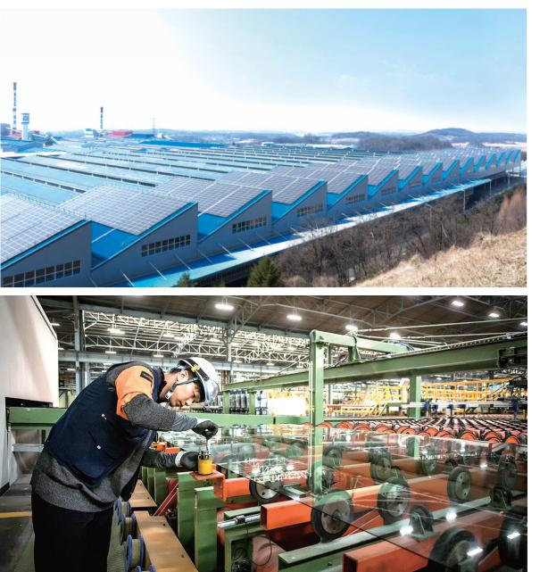
1) Edge Deletion: 실란트와 코팅막 간의 접착력 약화를 방지하기 위하여 실란트와 맞닿는 코팅유리 엣지(Edge) 부위의 코팅막을 제거하는 공정
